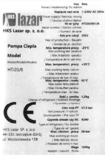
Fot. 1 Nieprawidłowa tabliczka znamionowa
