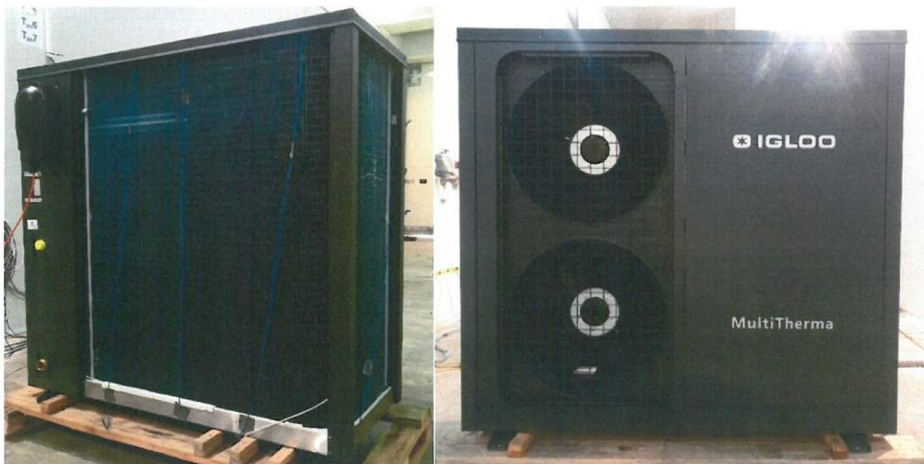
Fot. 3-4 Badana pompa ciepła przed badaniami wydajności i eksploatacyjnymi Fot. 3-4 Tested heat pump before performance and operational tests
