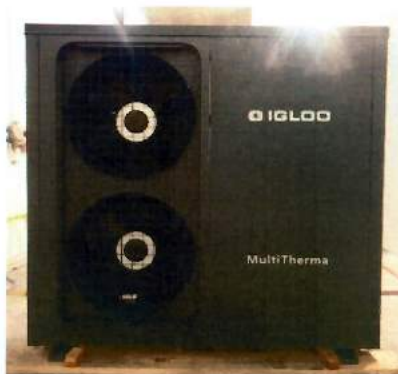
Fot. 1-2 Pompa ciepła przed modyfikacją obudowy – badania zgodnie z PN-EN 14825:2019-03 Photo 1-2 Heat pump before housing modification – tests in accordance with PN-EN 14825:2019-03
