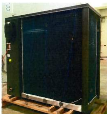
Fot. 1-2 Pompa ciepła przed modyfikacją obudowy – badania zgodnie z PN-EN 14825:2019-03 Photo 1-2 Heat pump before housing modification – tests in accordance with PN-EN 14825:2019-03
