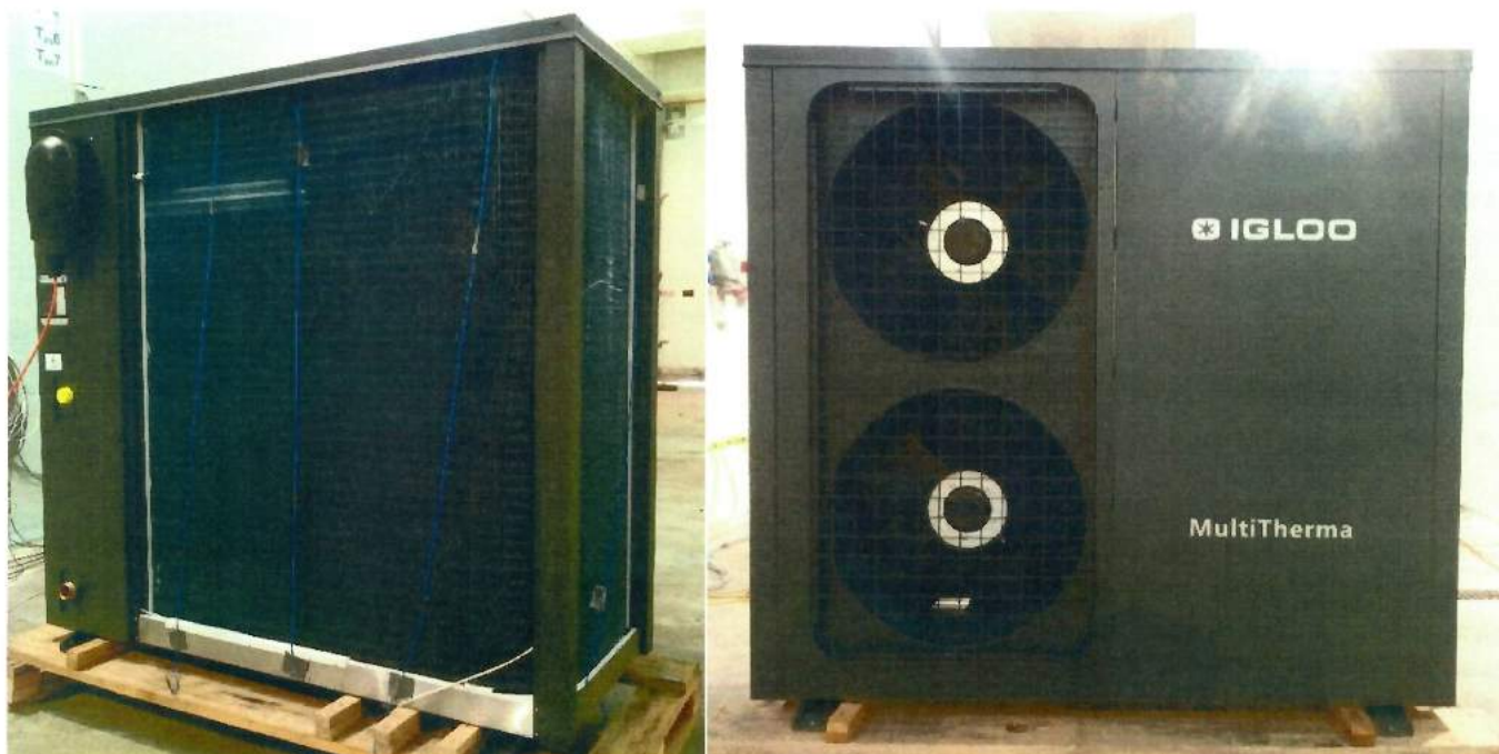
Fot. 3-4 Badana pompa ciepła przed badaniami wydajności i eksploatacyjnymi Photo 3-4 Tested heat pump before performance and operational tests
