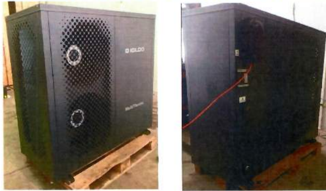
Fot. 3-4 Pompa ciepła po modyfikacji – badania zgodnie z PN-EN 12102-1:2022-11 Photo 3-4 Heat pump after modification – tests in accordance with PN-EN 12102-1:2022-11
