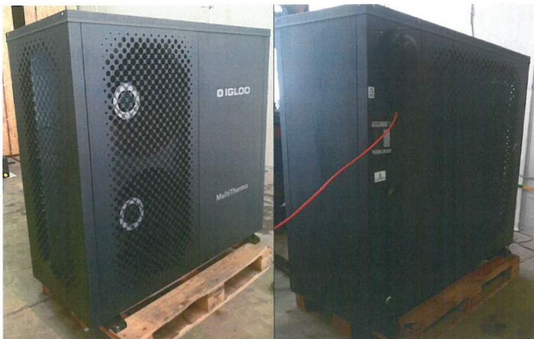
Fot. 5-6 Badana pompa ciepła przed badaniami poziomu mocy akustycznej Fot. 5-6 Tested heat pump before sound power tests
