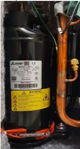
Kompressor (Compressor)
