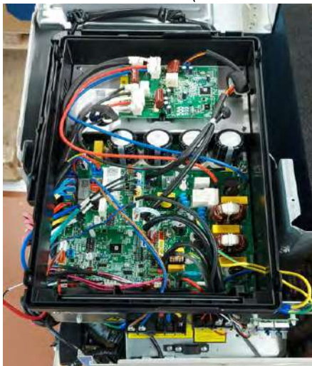
Elektrische Einheit ODU (Electrical unit ODU)
