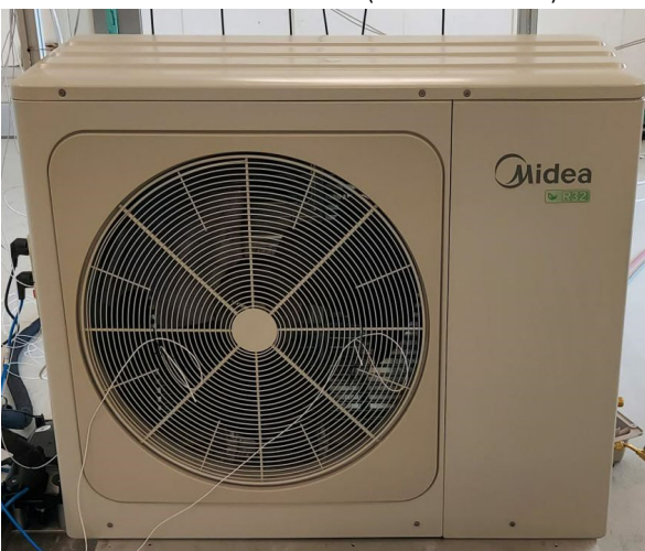
Gesamtansicht Ausseneinheit (General view ODU)
