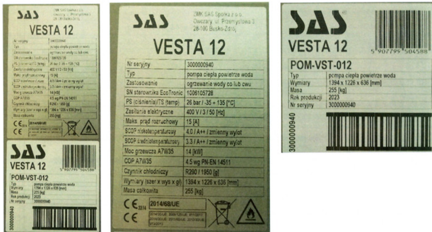
Fot. 3+5 Tabliczki znamionowe badanej pompy ciepła Fot. 3+5 Nameplates of the tested heat pump
