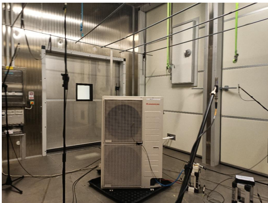
Figura 4 – Istallazione dell'unità esterna della sorgente di rumore nella seconda posizione (position 2) – Installation of the outdoor unit of the sound source in the second position (position 2).)
