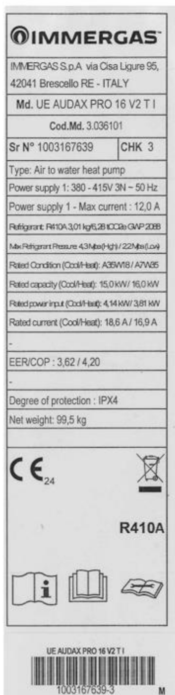
Figura 1 Etichette unità esterna campione in prova – Outdoor unit data plates of the device under test
