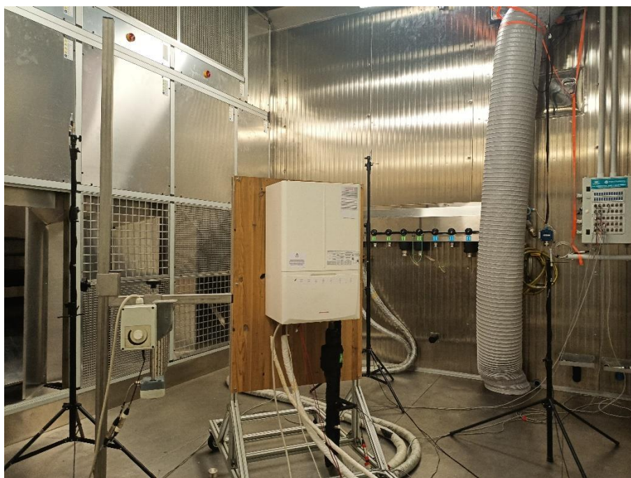
Figura 5 – Istallazione dell'unità interna della sorgente di rumore nella prima posizione (position 1) – Installation of the indoor unit of the sound source in the first position (position 1).
