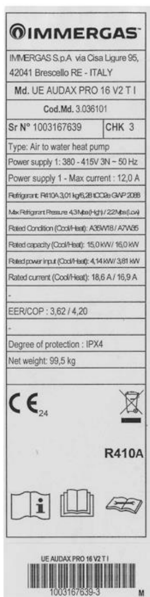
Figura 1 Etichette unità esterna campione in prova – Outdoor unit data plates of the device under test
