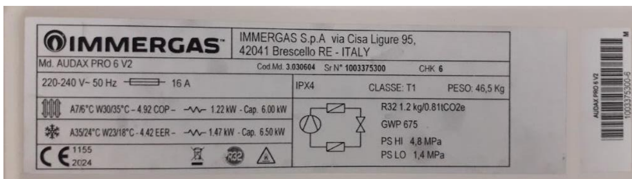
Figura 1 Etichetta unità esterna campione in prova – Outdoor unit data plate of the device under test
