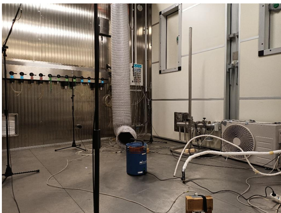
Figura 7 – Installazione della sorgente di rumore di riferimento nella posizione dell'unità esterna – Installation of the reference sound source at the outdoor unit position.
