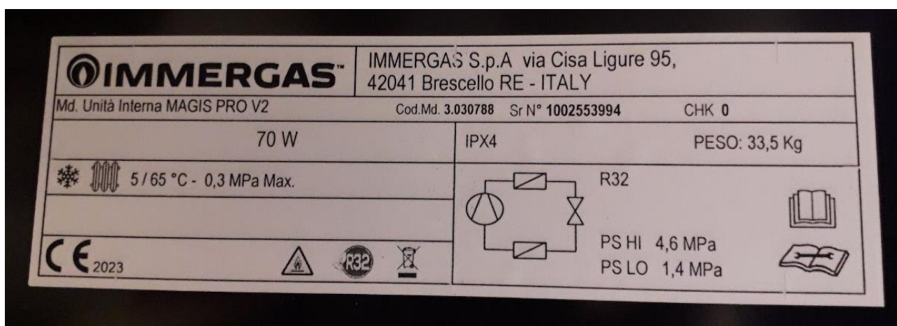
Figura 2 Etichetta unità interna campione in prova – Indoor unit data plate of the device under test
