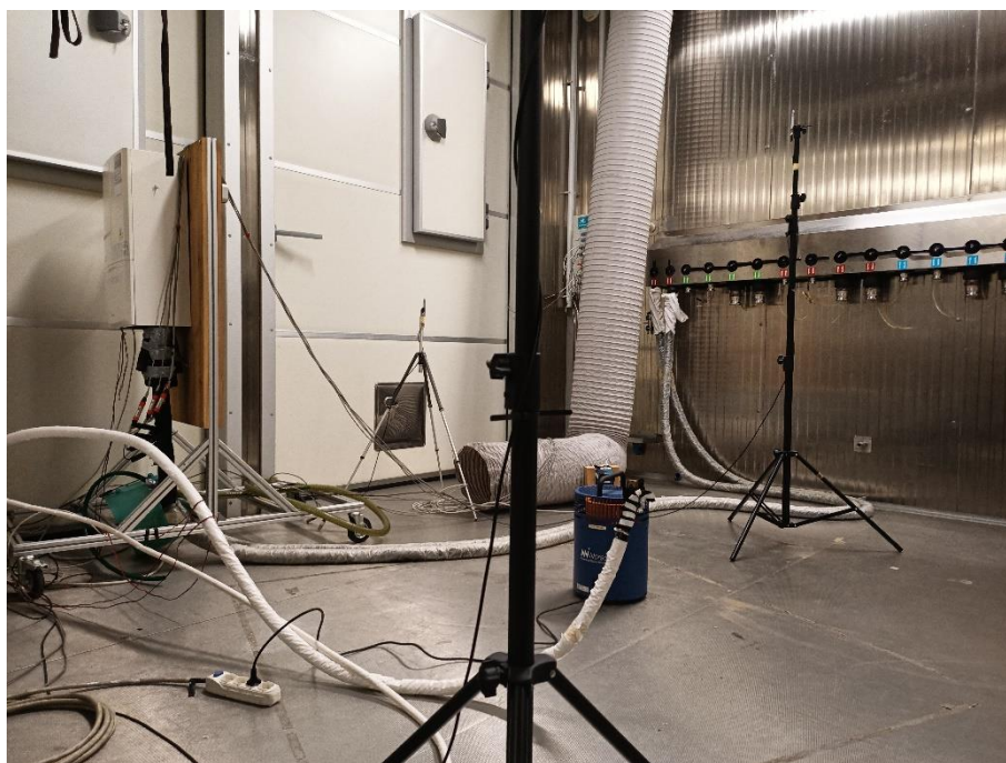
Figura 8 – Istallazione della sorgente di rumore di riferimento nella posizione dell'unità interna – Installation of the reference sound source at the indoor unit position.
