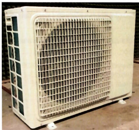
Fot. 1-2 Badana pompa ciepła – jednostka zewnętrzna Photo 1-2 Tested heat pump – outdoor unit
