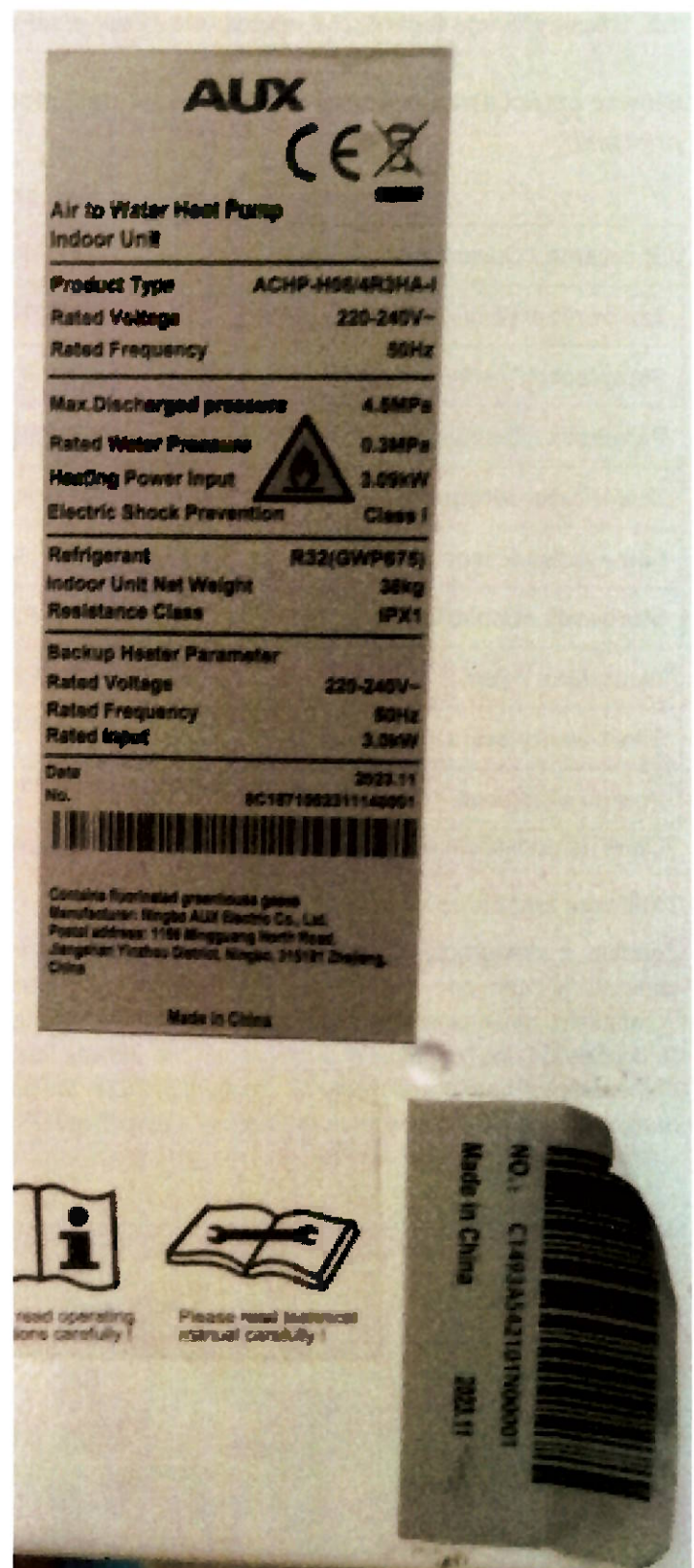
Fot. 5 Błędne tabliczki znamionowe jednostki wewnętrznej Photo 5 Incorrect nameplates indoor unit
