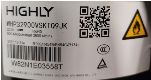
Bild 4 / Picture 4 Typenschild Verdichter Name plate compressor
